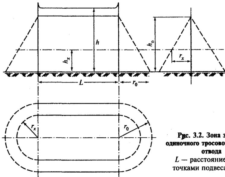
**Рис. 3.2. Зона защиты одиночного тросового молниеотвода**
