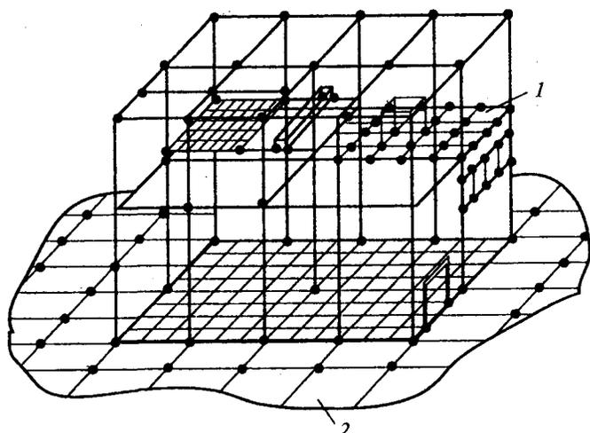
Рис. 4.7. Сетчатое заземляющее устройство здания:
