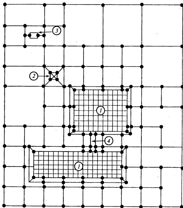
Рис. 4.8. Сетчатое заземляющее устройство производственных сооружений:
